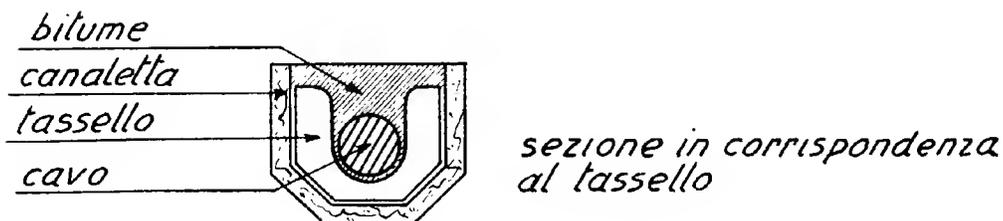
Fig. 271 - Particolare della cassetta con bitume.
